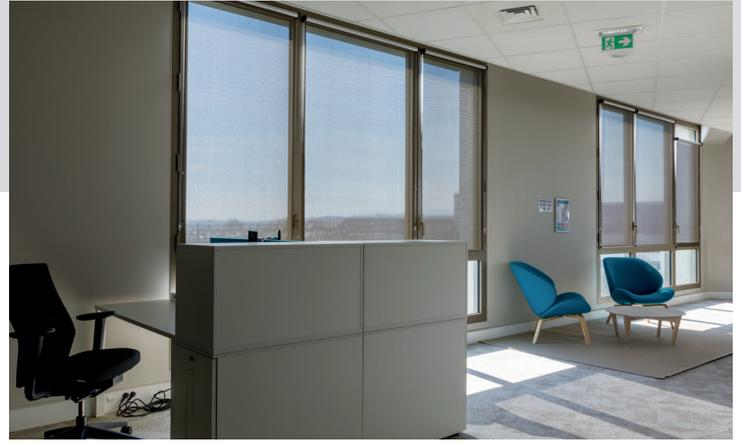
Mit seiner zur Verglasung ausgerichteten **metallisierten** Seite bietet das Gewebe Screen Nature Ultimetal® aus technischer Sicht eine hohe **Sonnenreflexion** (74 %), ein geringes Emissionsvermögen von 10 % sowie eine **ausgezeichnete Durchlässigkeit für sichtbares Licht** ( $T_v = 6\%$ ) – und das bei jedem Farbton.
