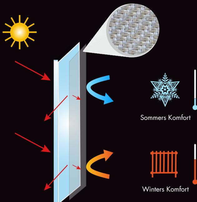
Der Emissionsgrad eines Werkstoffs entspricht der Fähigkeit desselben, die aufgenommene Energie durch Übertragungswirkung erneut abzugeben (Wärme/Kälte).
